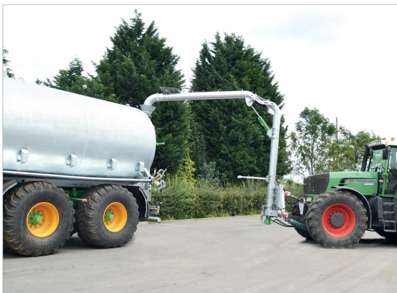
El purín es aspirado vía el tubo 8" ( $\varnothing$  200 mm). El turbo-llenador de 8" montado de manera compacta en la base del brazo permite acelerar el pasaje del purín dentro del conducto situado bajo el tractor (6 o 8"). La placa de protección situada en la extremidad del turbo asegura la protección del motor hidráulico en caso de contacto con el suelo. El tubo de gran diámetro combinado al turbo-llenador garantizan una velocidad de llenado crecida.
